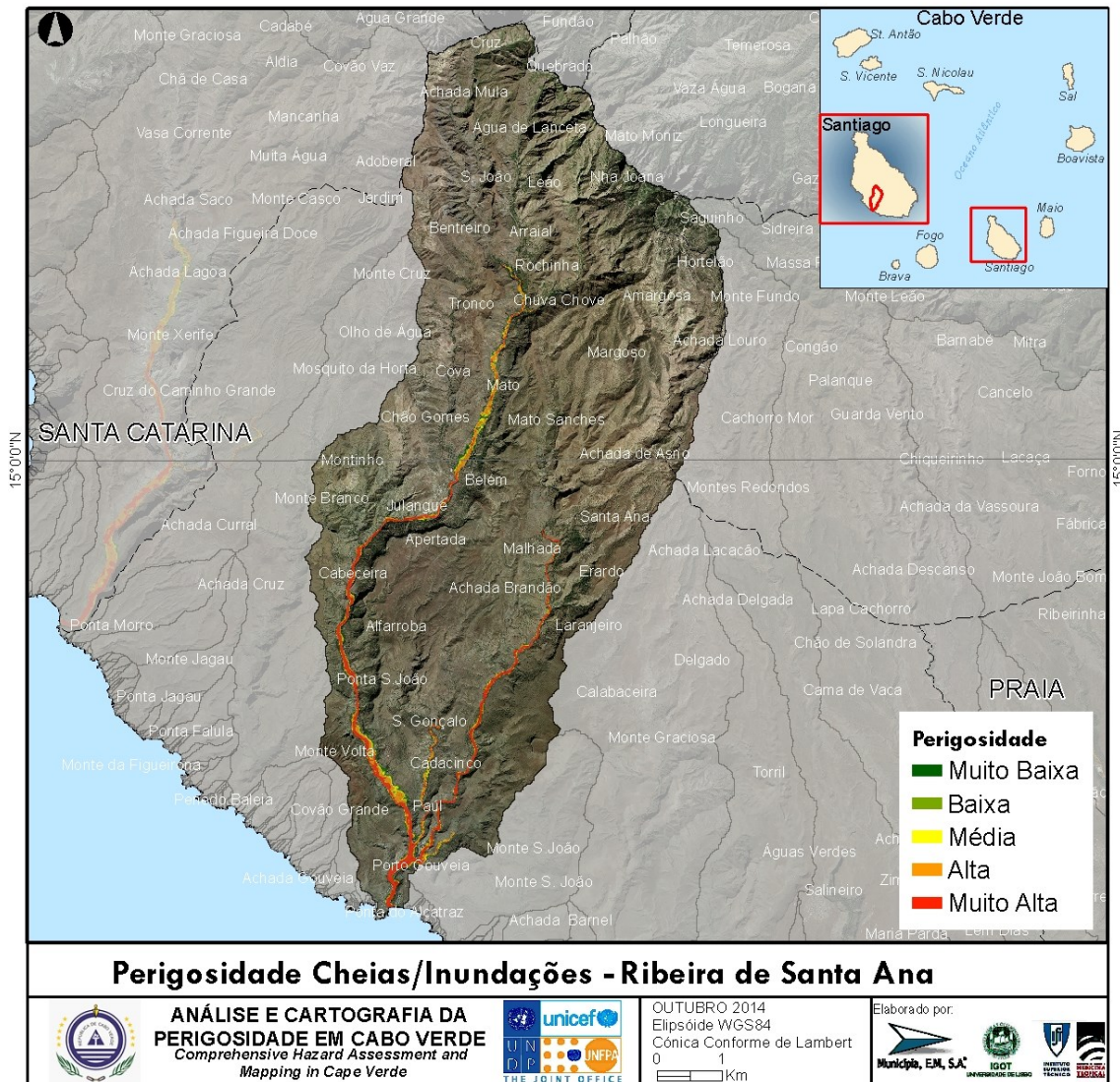
Figura 35 - Perigosidade Cheias/Inundações - Ribeira de Santa Ana
